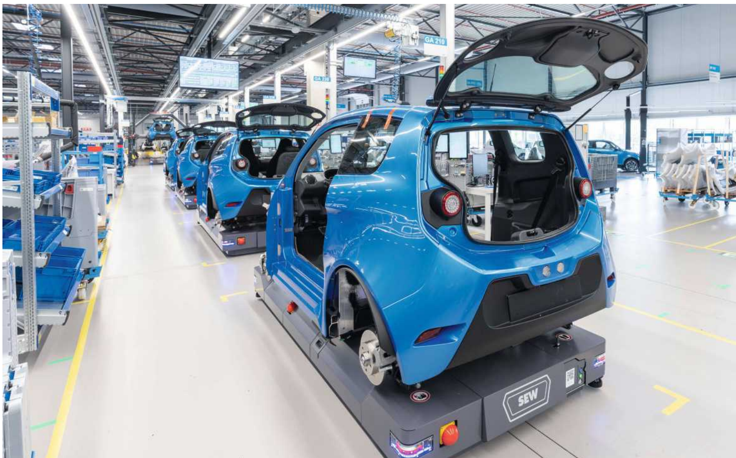
Die Fabrik des e.GO braucht weder Press- noch Lackierwerk. Die fertigen Kunststoffteile werden auf einen Alu-Rahmen montiert
