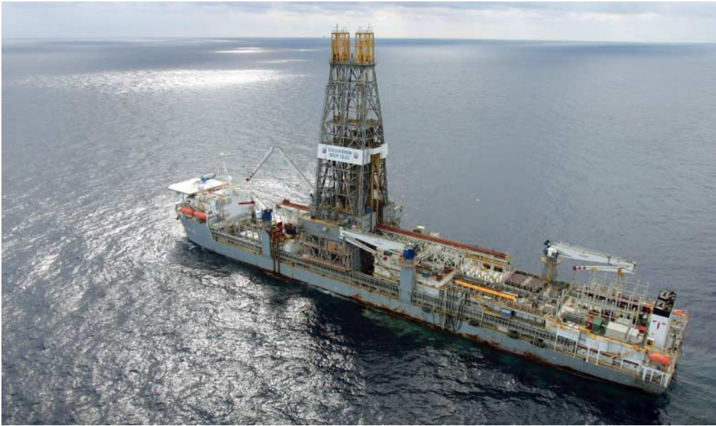
Schweres Gerät: Das Bohrschiff „Discover Deep Seas“ verfügt über einen Doppelbohrturm. Schiffsbetreiber Transocean will auf diese Weise Zeit und Kosten sparen.
