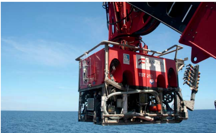
Metallfresser: Das ferngesteuerte Abbaugerät der Firma Nautilus Minerals soll sulfidische Erzlagerstätten an Schwarzen Rauchern abweiden.
