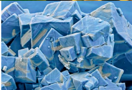
Würfel für Wasserstoff: Mit den „Nanocubes“ von BASF lässt sich das flüchtige Gas in Tanks festhalten
